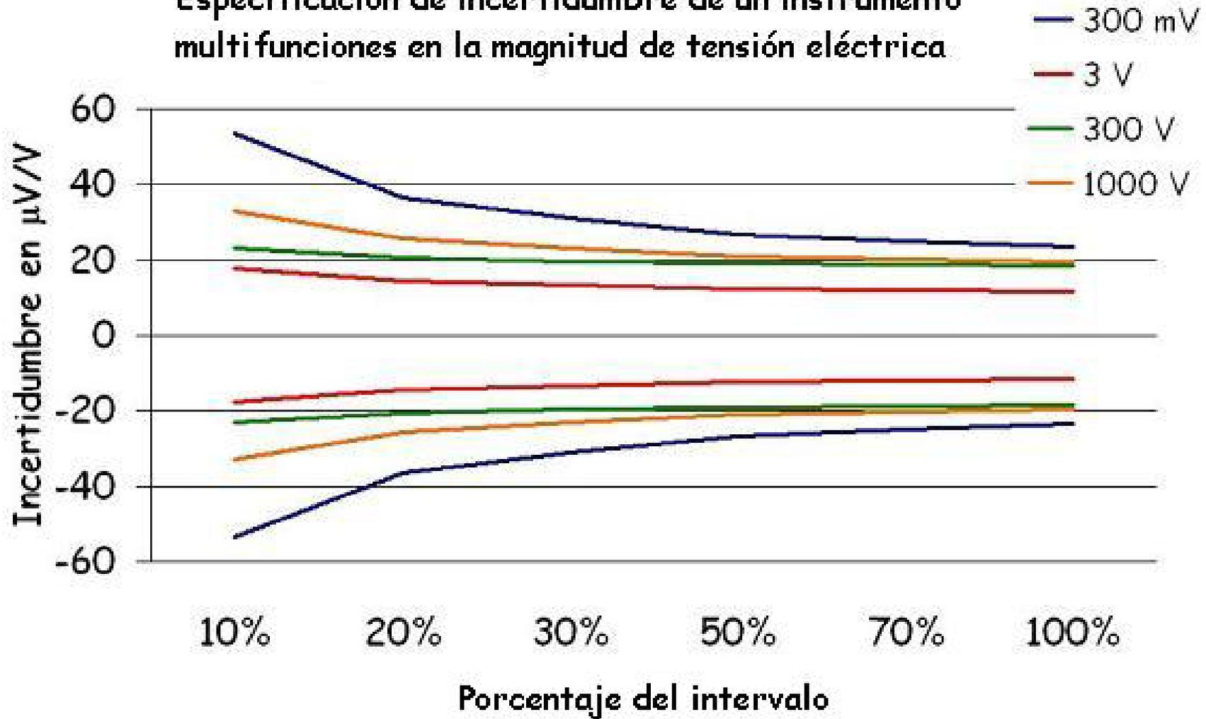
Instrumento multifunciones en la magnitud de tensión eléctrica en corriente continua en el alcance de 330 mV
